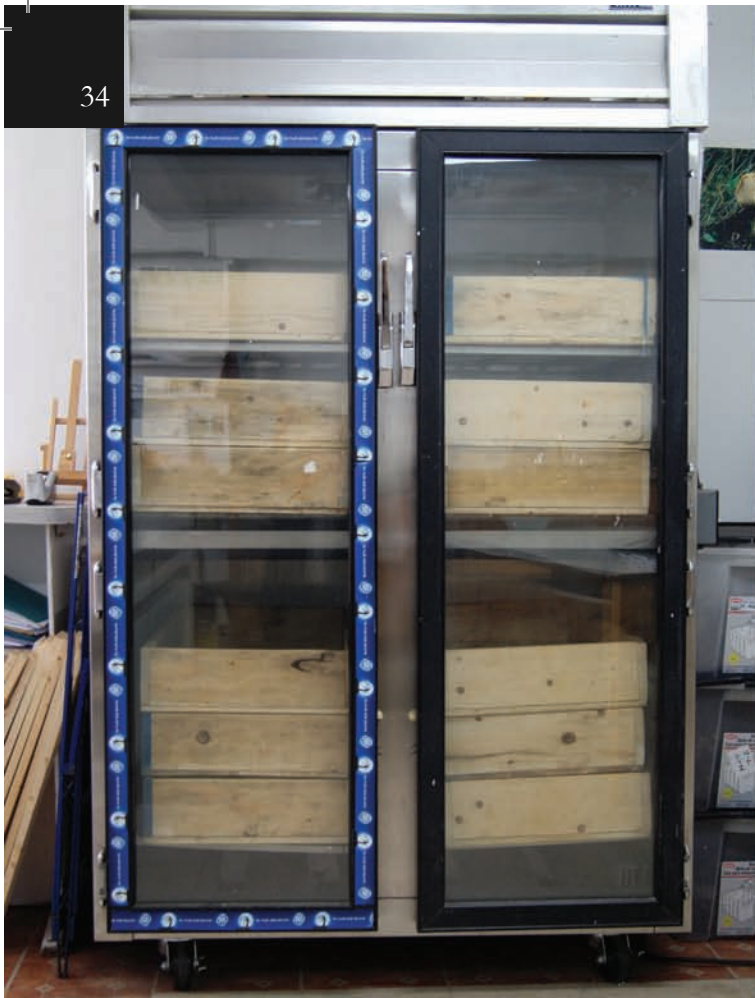
1, 2 - Assécheur fabriqué à partir d'un réfrigérateur de dépanneur chez l'Autre Forêt - Fernand Miron
